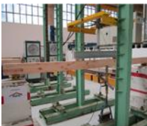
Ensayo a flexión, viga de madera (YOFRÁ)
