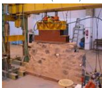
Ensayos a compresión, cortante y flexión en fábricas
