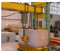
Ensayo de cajetones de anclaje de cajones (ULMA)
